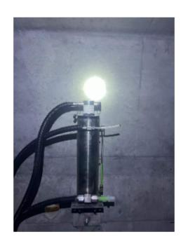
高精度静力水准仪适用于要求较高的垂直位移或沉降变形监测,可监测到0.01mm的液位变化。仪器由一系列含有液位传感器的容器组成,多个容器间由充满液体的连通管连接在一起。基准容器位于稳定的基准点上,任何一个容器与基准容器间的高程变化都将引起相应容器内的液位变化。通过测量液位变化即可获取测点的高程变化。高精度静力水准仪采用全球范围内品质压力敏感元件,静力水准仪产品采用-20-60°℃度整机多点全量程温度补偿工艺,具有测星精度高、无漂移、可靠性强、安装方便等优点。密封的外壳防潮性能好,可在相对湿度环境下长期连续工作。郑州静力水准仪型号磁致伸缩式静力水准仪测量方式是将多个静力水准仪的容器用通液管联接。
