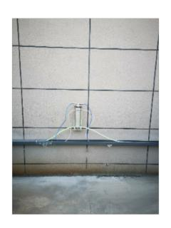
静力水准仪详细安装过程: 1、测墩安装时注意每个测墩高程一致,各仪器墩面高程用水准仪或其他方式找
