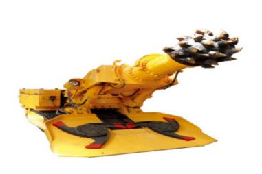
掘进机冷却和喷雾系统改造:综合分析了掘进机冷却系统不能有效冷却切割电机和泵站电机,随着电机温度的逐渐升高,电机内部绝缘材料碳化变质,导致电机损坏;不能有效消除液压系统中液压泵、溢流阀和流量控制阀所产生的热量,随着液压油温度的升高,液压密封件变形,液压元件磨损损坏等。喷雾除尘系统中的缺点易造成切割臂损坏;不能精确控制喷雾除尘系统的雾水量和喷雾时间;冷却系统和喷雾系统的水直接排至巷道内,容易造成巷道积水,底板围岩变软,掘进机下陷;喷雾除尘系统无法远程控制等问题产生的原因,对冷却系统和喷雾除尘系统进行了改造,取得了良好的效果。
